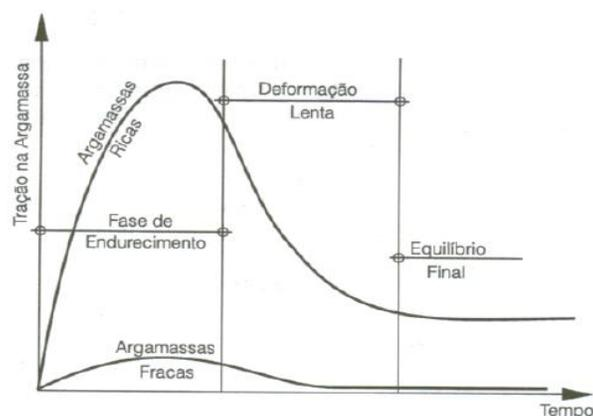
Figura 2.9 – Comportamento das tensões nas argamassas, FIORITO (1994)
