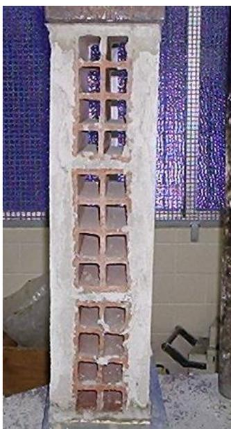
Figura 3.14 – Prismas com revestimento de 3 cm de espessura
