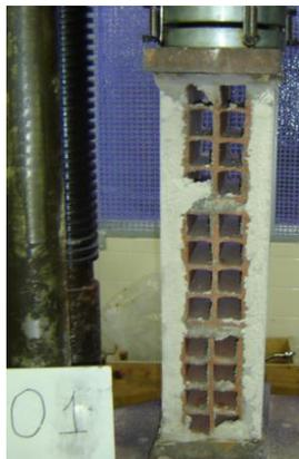
Figura 2.21 – Prisma em ensaio
