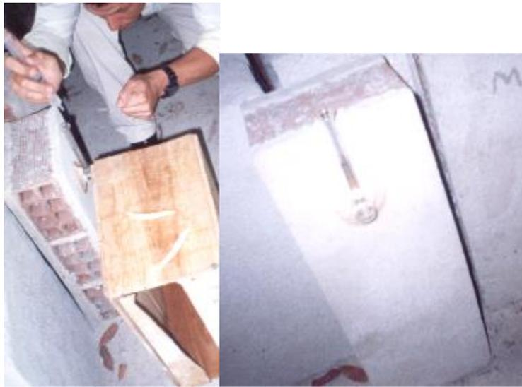
Figura 3.8 – Ensaio de permeabilidade
