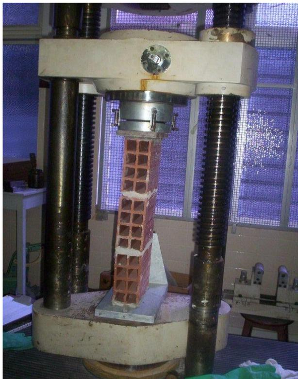
Figura 2.17 (b) – Prisma com três blocos de vedação
