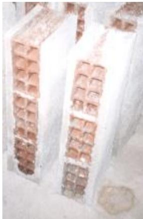
Figura 3.13 – Prismas com revestimento de 2 cm de espessura
