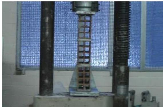
Figura 6.6 (a) – Prisma nu antes da ruptura
