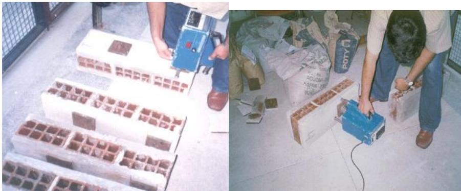
Figura 3.9 – Ensaio de resistência de aderência à tração
